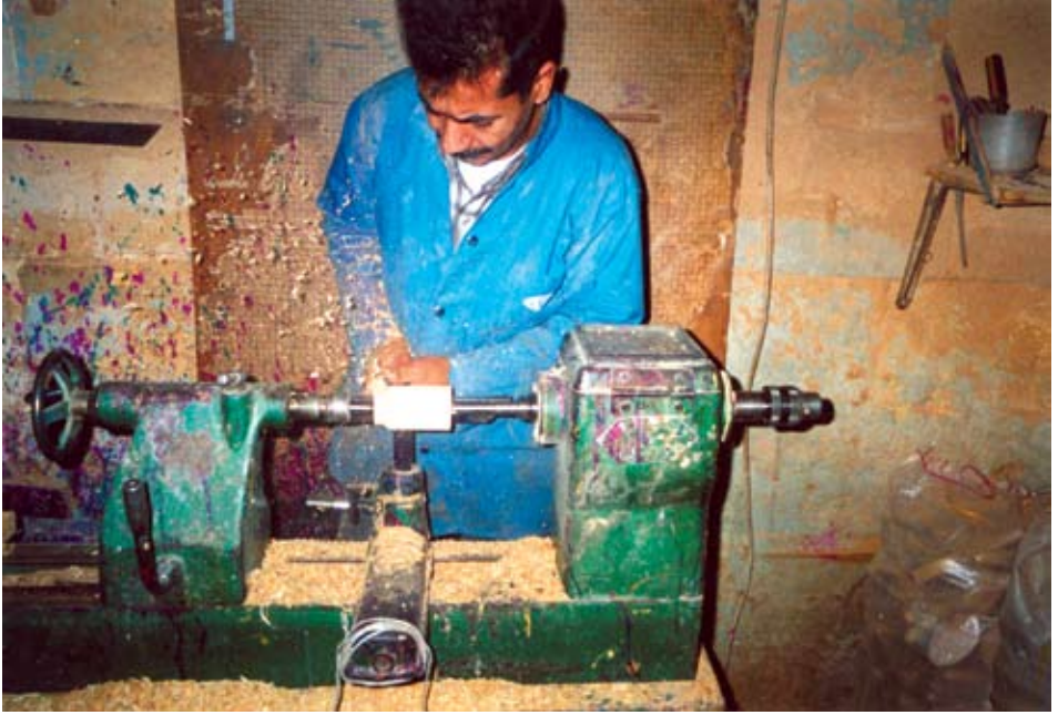
Fotoğraf 204: Topaç Çevirmece oyunu: Döneren çam dalına, ucu düz demir çubuk temas ettirilerek şekil verme işlemine başlanır.
