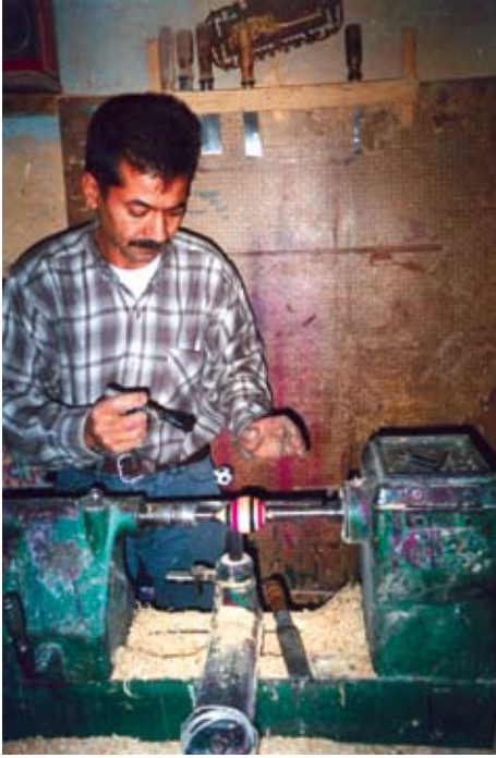
Fotoğraf 206: Topaç Çevirmece oyunu: Torna makinesine yerleştirilen topaç, el sabit tutularak boyanır.
