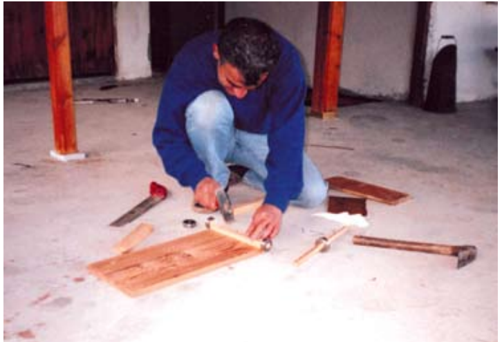
Fotoğraf 171: Tornet oyunu: Rulmanları takılmış takozun tahtanın arkasına çakılması.
