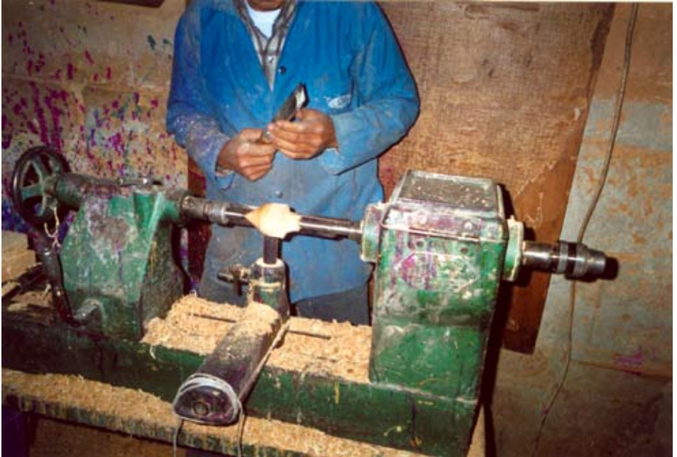
Fotoğraf 205: Topaç Çevirmece oyunu: Çam dalınının, uç tarafı sivri, arka tarafı yuvarlak olarak biçimlendirilir.
