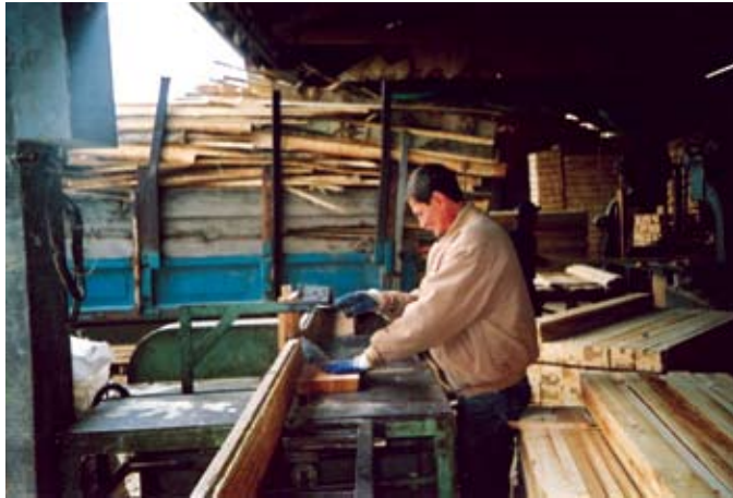
Fotoğraf 162: Kös oyunu: Kös tahtasını oluşturmak için kestane ağacının gövdesinin dikdörtgen halinde kesilmesi.
