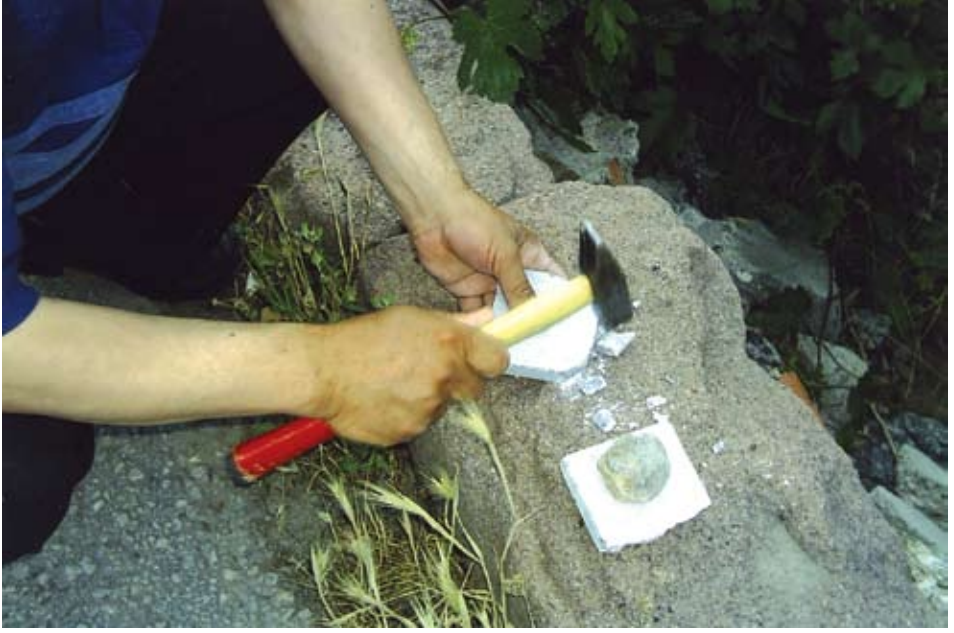
Fotoğraf 190: Naldırnaç: "Naldırnaç" ismindeki yassı taşların çekiçle kırılarak yassı hale getirilmesi.
